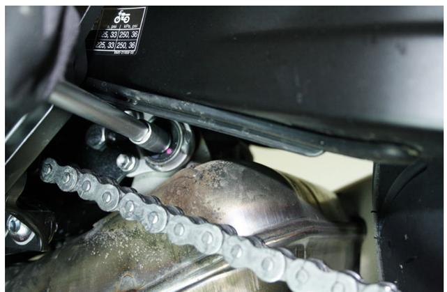
5. Lösen Sie nun alle 4 Muttern an den Stehbolzen der Zylinder, entfernen Sie dann die bereits lockere Schraube am Endschalldämpfer und entfernen Sie die gesamte Anlage in einem Stück.
